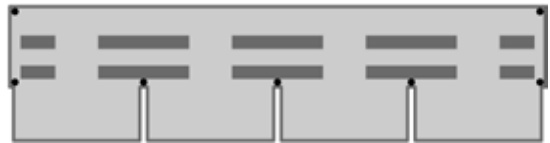
Рис. 12 Схемы расположения гвоздей.
